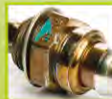
Uso de Ferramenta inadequada
