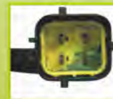
Oxidação no conector
